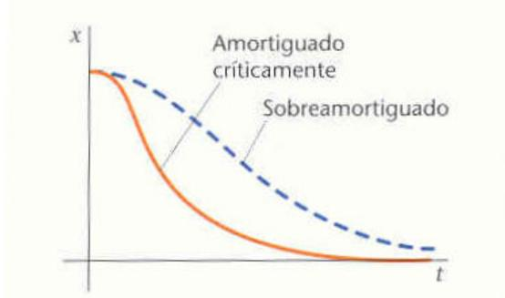
Figura 1.18. Sistemas amortiguados críticamente y sobreamortiguados
